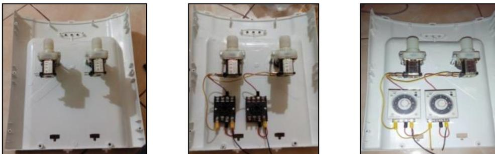
Gambar 6. Pemasangan Keran Otomatis / Solenoid Valve dan TDR (Time Delay Relay)
